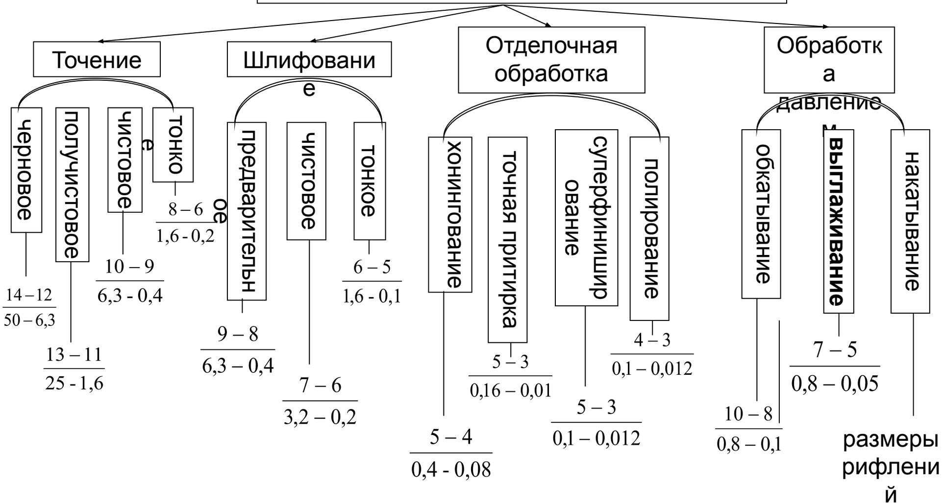
Рисунок 2 – Методы обработки наружных цилиндрических поверхностей
