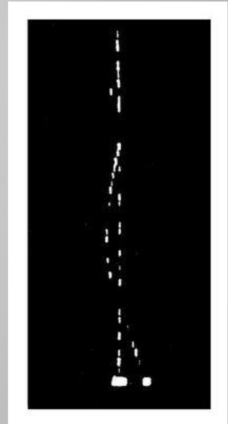
Трек частицы в узкоззорной искровой камере
