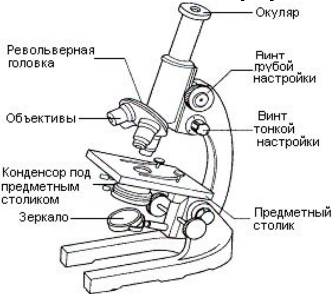
**Предел разрешения микроскопа (Z) - наименьшее расстояние между двумя точками предмета, при котором они различимы как отдельные объекты (т.е. воспринимаются в микроскопе как две точки).**
