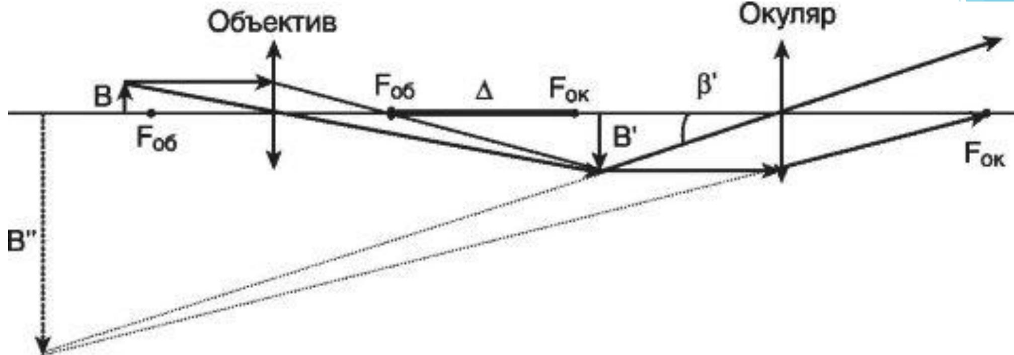
Увеличение микроскопа - отношение угла зрения  $\beta'$ , под которым видно изображение предмета в окуляре, к углу зрения  $\beta$ , под которым предмет виден «невооруженным» глазом с расстояния наилучшего зрения ( $a_0$ ):
