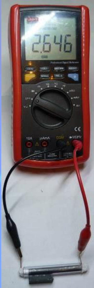
Рис. 9. Мультиметр с когерером, наполненным порошком железа и магнитом .
