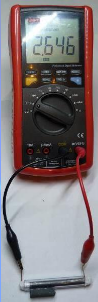
Рис. 9. Мультиметр с когерером, заполненным порошком железа и магнитом .
