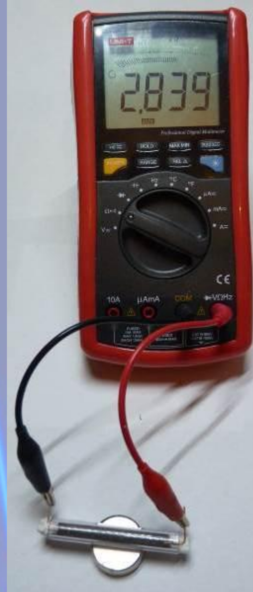
Рис. 10. Мультиметр с когерером, наполненным порошком железа и супермагнитом .
