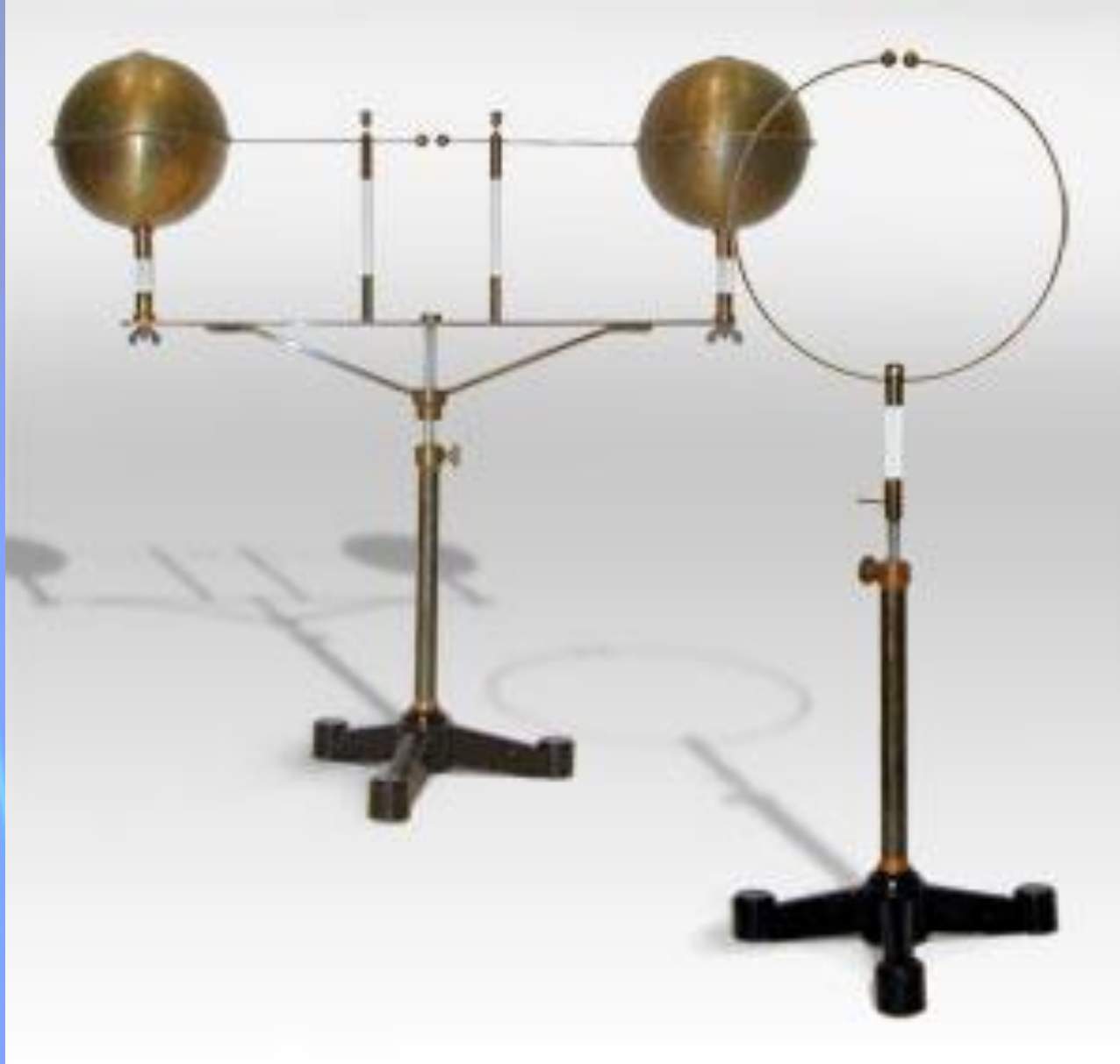
Рис. 1. Приборы, использовавшиеся Генрихом Герцем (на переднем плане приёмник на заднем - передатчик).
