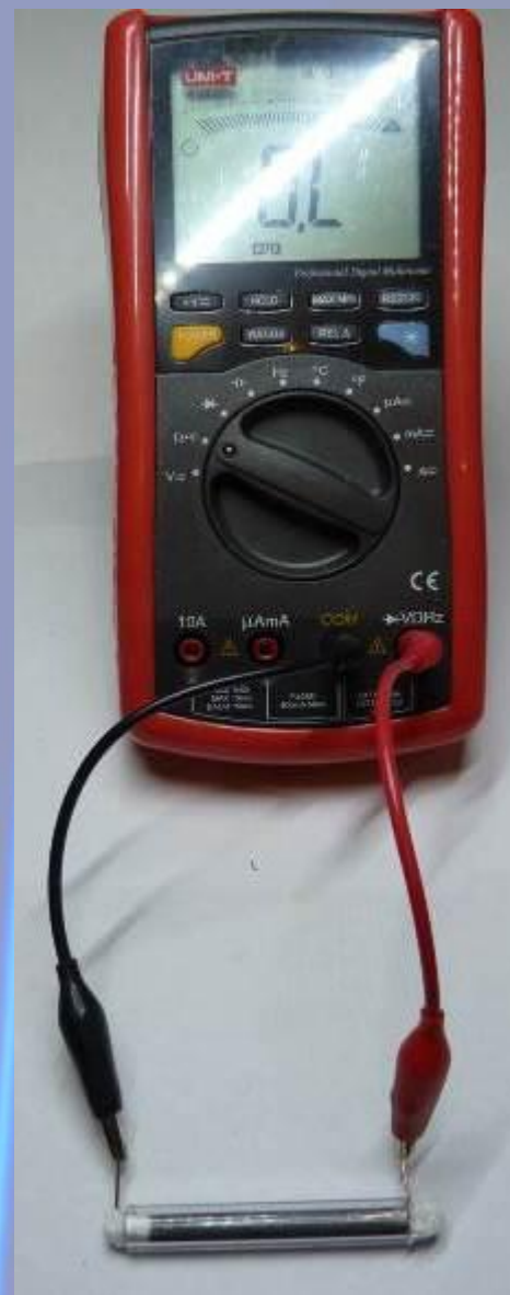
Рис.8 . Мультиметр с когерером, заполненным порошком железа .
