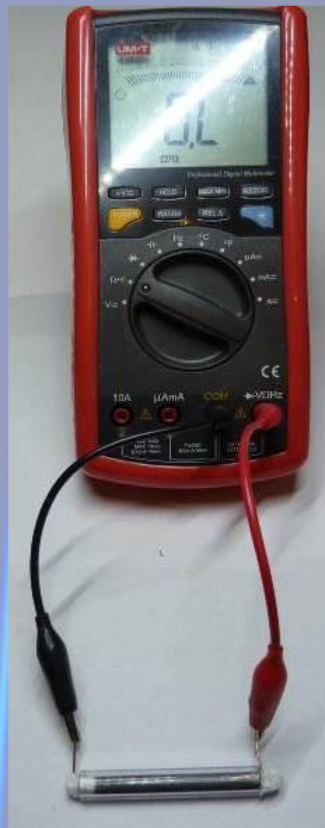
Рис.8 . Мультиметр с когерером, заполненным порошком железа .
