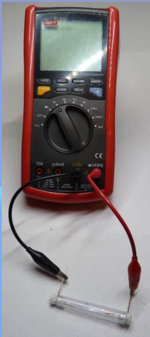
Рис. 7. Мультиметр с незаполненным когерером
