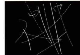
Треки заряженных частиц в пузырьковой камере
