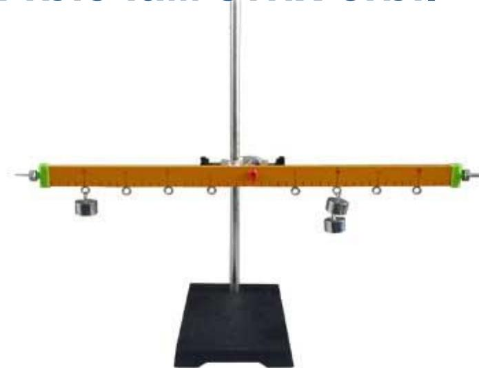
Рычаг-линейка применяется для выяснения условий равновесия рычага и проверки правила моментов сил. Может ли данный рычаг находиться в равновесии?
