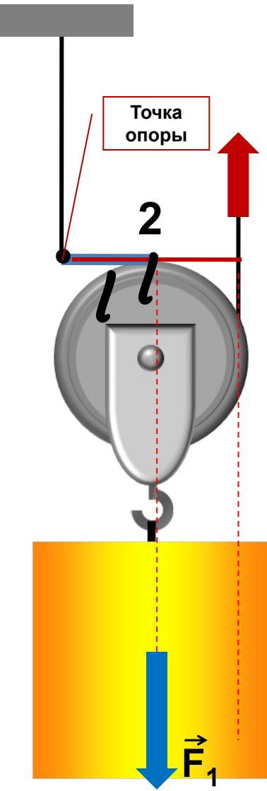
Подвижный блок – это блок, ось которого поднимается и опускается вместе с грузом.
