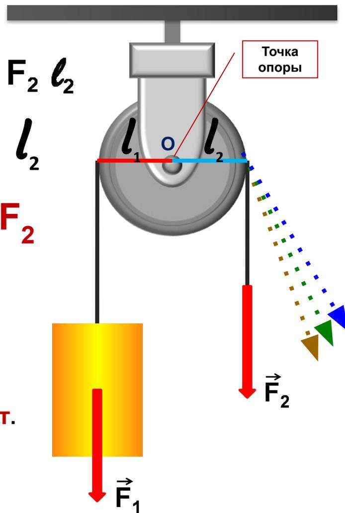
Неподвижный блок – это блок, ось которого закреплена и при подъеме груза не поднимается и не опускается.
