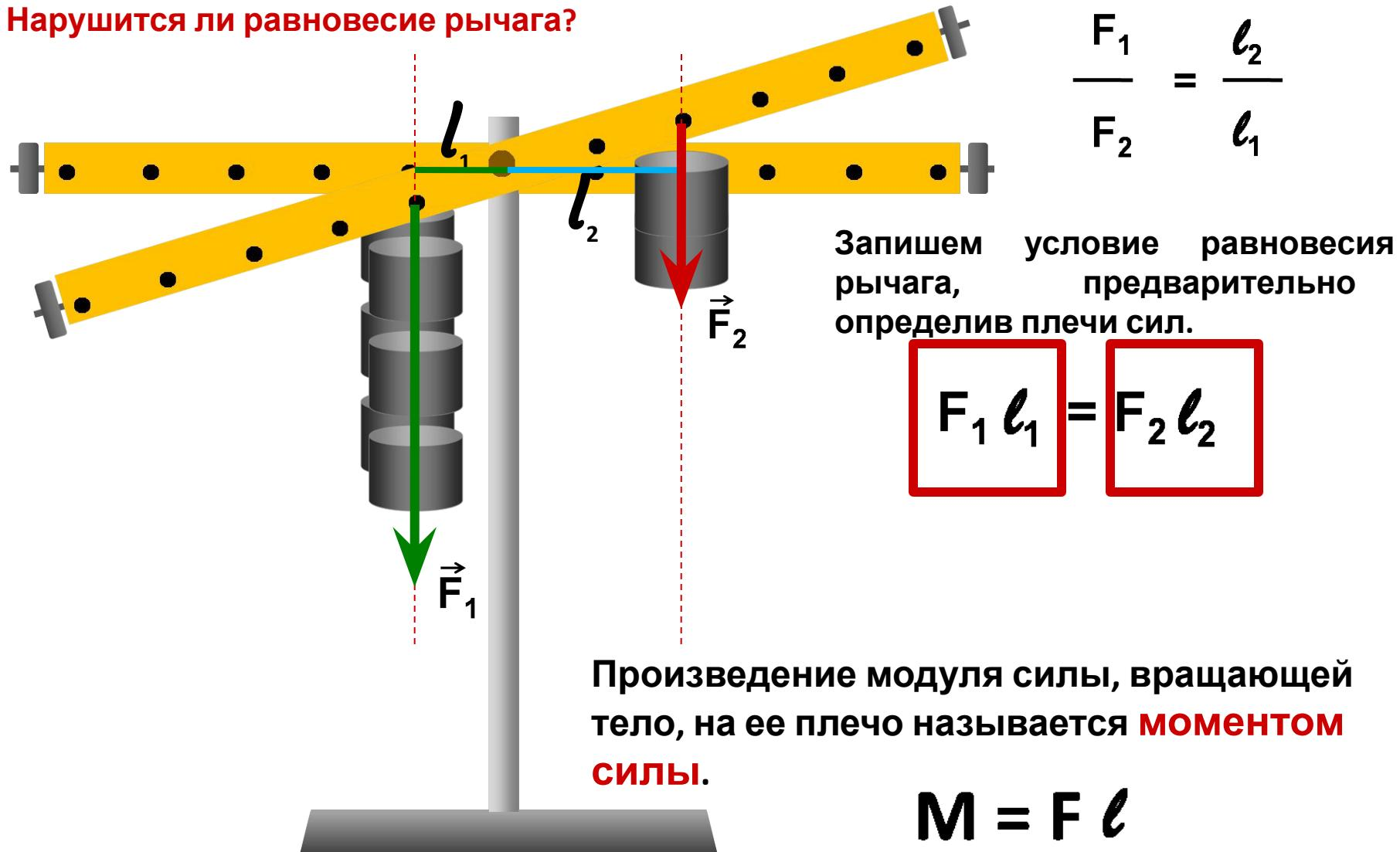
**Рычаг находится в равновесии под действием двух сил, если момент силы, вращающий его по часовой стрелке, равен моменту силы, вращающей его против часовой стрелки.**
