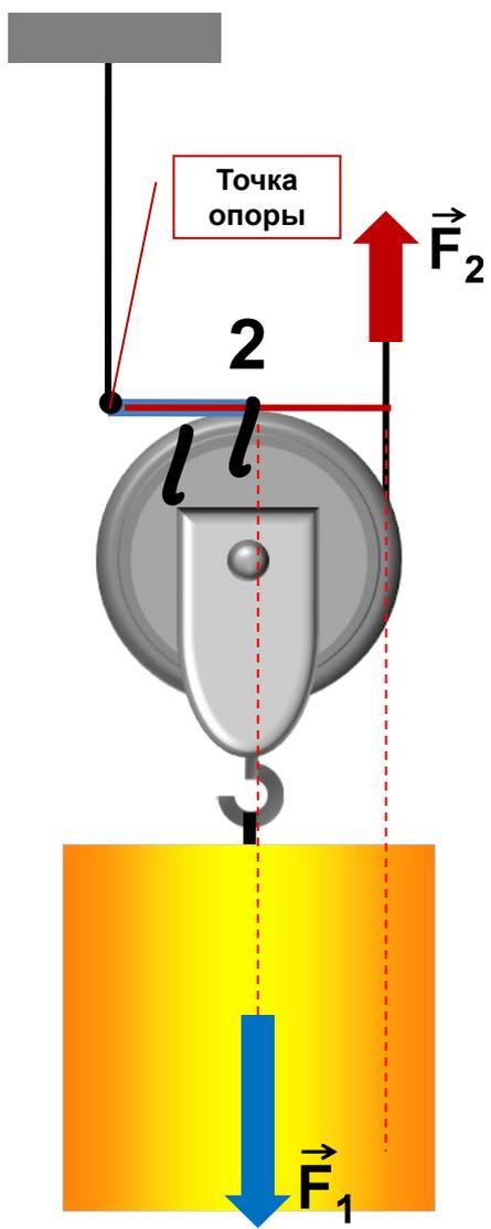
Подвижный блок – это блок, ось которого поднимается и опускается вместе с грузом.
