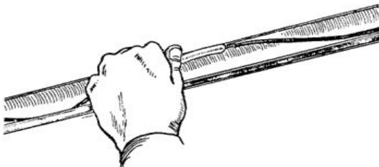
Изолирование спайки стального троса полиэтиленовой гильзой
