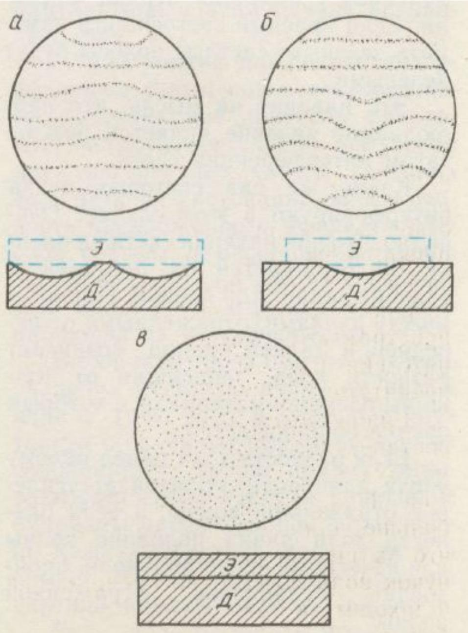
□ Несовершенство обработки определяют по искривлению интерференционных полос, образующиеся при отражении от проверяемой поверхности.
