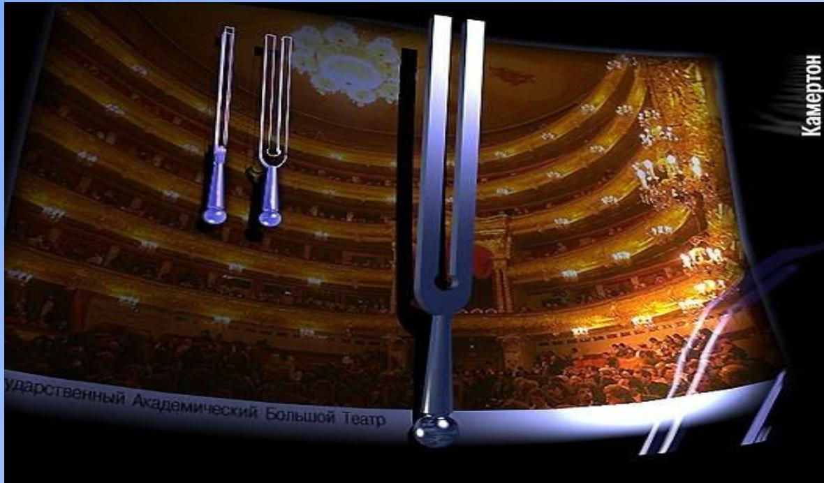
КАМЕРТОН (нем. Kammerton ) служит эталоном высоты звука при настройке музыкальных инструментов и в пении. Принята эталонная частота тона ля первой октавы — 440 Гц.
