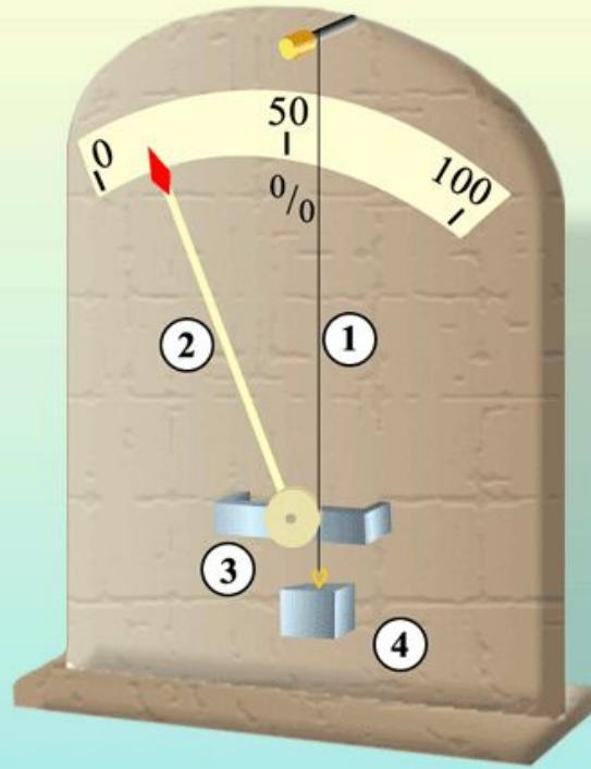
Принцип действия волосного гигрометра основан на свойстве обезжиренного волоса (человека или животного) **изменять свою длину в зависимости от влажности воздуха**, в котором он находится.
