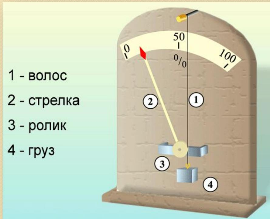
Принцип действия волосного гигрометра основан на свойстве обезжиренного волоса (человека или животного) **изменять свою длину в зависимости от влажности воздуха**, в котором он находится.
