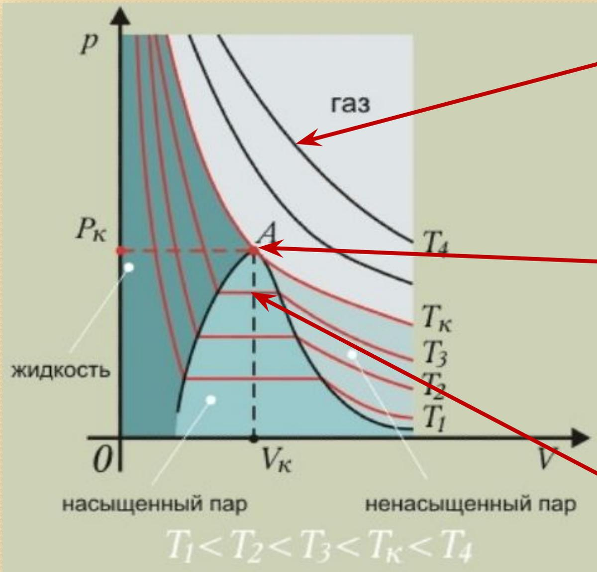
Если температура газа выше критической, то ни при каком давлении газ не перейдет в жидкое состояние.
