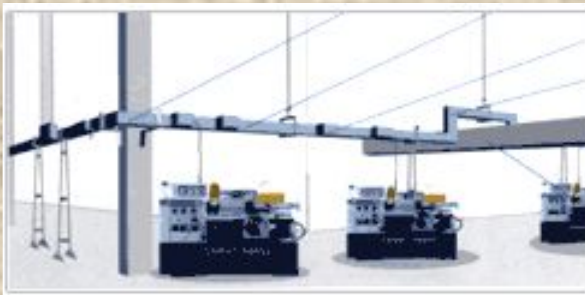
Пример электрической сети, выполненной шинопроводами
