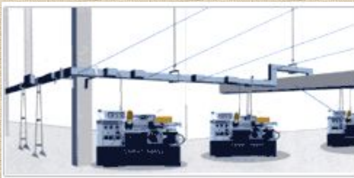
Пример электрической сети, выполненной шинопроводами
