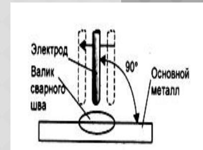
○ При сварке стыковых соединений с разделкой кромок в зависимости от толщины свариваемых листов (от 3 до 26 мм), положения шва в пространстве, диаметра электрода сварку выполняют в два и более слоев. Выполнение шва начинают с наложения первого слоя, состоящего из одного валика.
