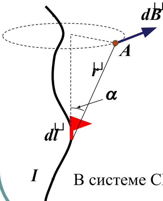
Направление  $d\vec{B}$ : перпендикулярно плоскости, в которой располагаются векторы  $d\vec{l}$  и  $\vec{r}$ ; его направление совпадает с направлением правого винта, вращающегося по кратчайшему пути от  $d\vec{l}$  к  $\vec{r}$ .
