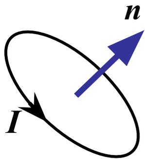
Вращающий момент зависит от магнитного поля. В то же время он зависит и от свойств контура: площади  $S$  и тока в контуре. Поэтому он не может служить силовой характеристикой поля. Свойства контура можно учесть через его *дипольный магнитный момент* :
