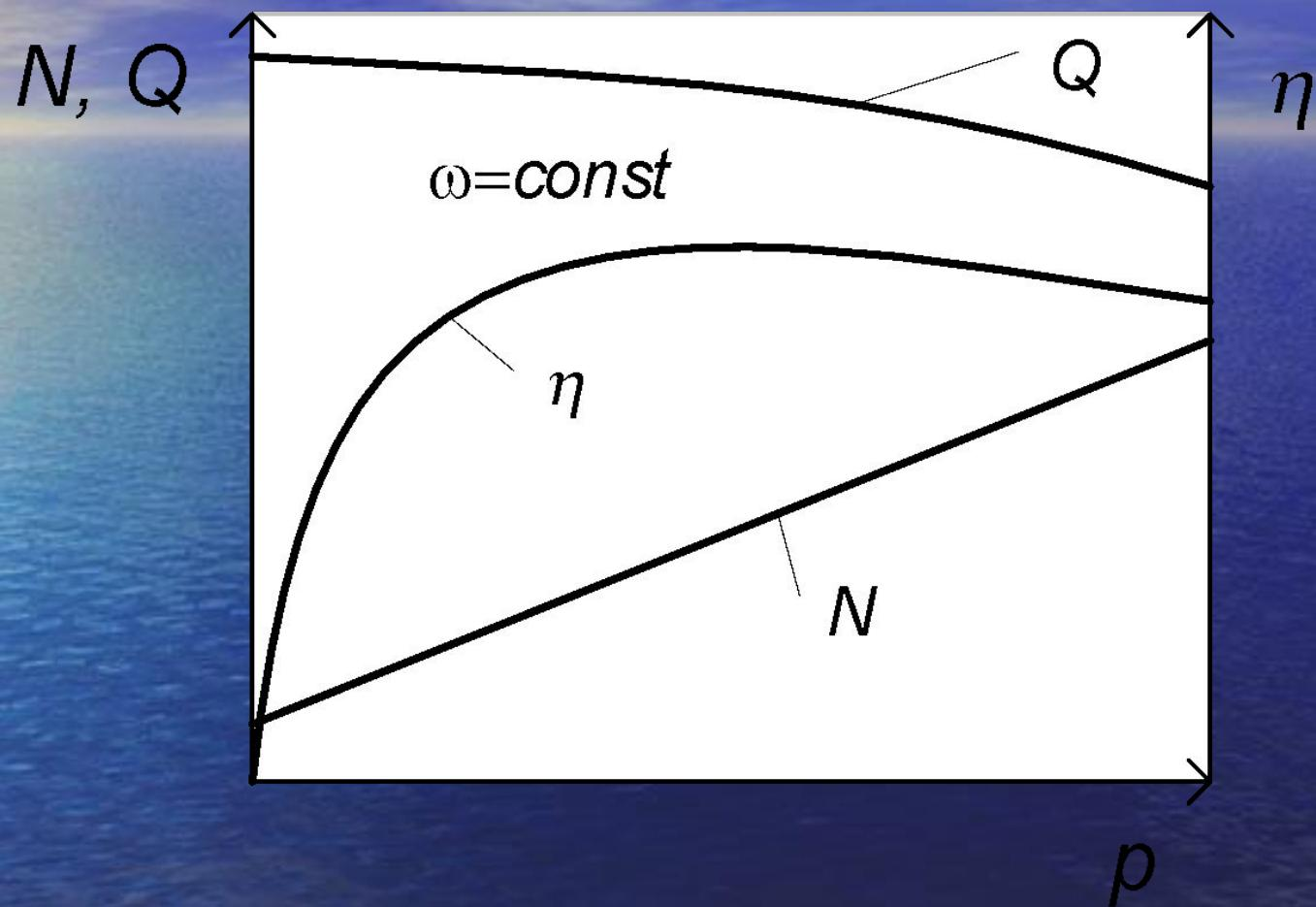
$Q$  – подача;  $N$  – мощность;  $\eta$  – КПД насоса;  $p$  – давление в линии нагнетания;  $\omega$  – частота вращения вала насоса
