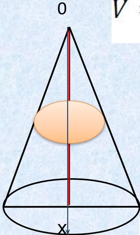
$$V = \frac{b - a}{6} (S_{\text{H.O.}} + 4S_{\text{ср.сеч.}} + S_{\text{B.O.}})$$
