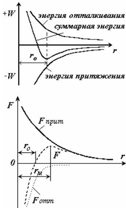
Рис. 1. Графики энергии и сил взаимодействия между ионами
