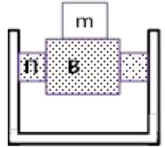
Жидкость не сжимаема  $\rightarrow$  втулка опускается вниз на  $\Delta h$ , поршень поднимается вверх на  $\Delta a$  при этом объем жидкости сохраняется:
