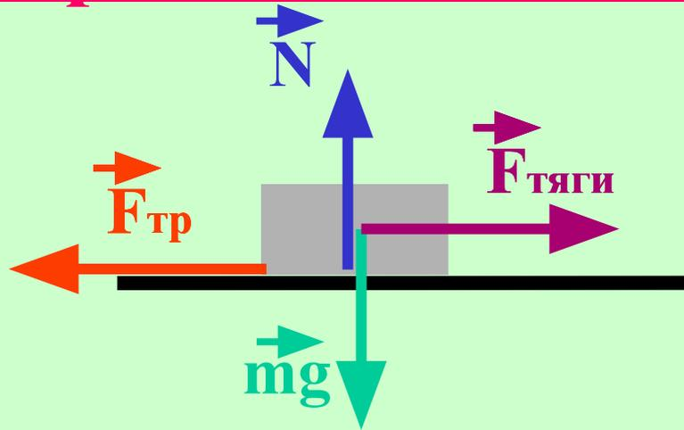
Силу трения, действующую между двумя телами, неподвижными относительно друг друга называют силой трения покоя.
