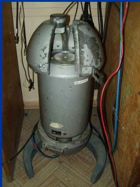
Рис. 4-Детектор гамма –спектрометра и его защита
