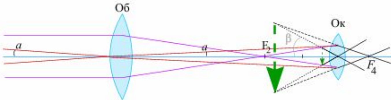
Рис. 228. Ход лучей в астрономическом телескопе (труба Кеплера).
