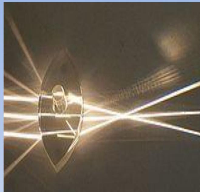
Линзы, которые преобразуют пучок параллельных лучей в сходящийся и собирают его в одну точку называют **собирающими** линзами.
