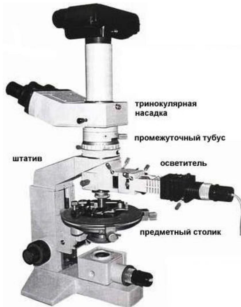
Рис. 1 Общий вид рудного микроскопа серии ПОЛАМ
