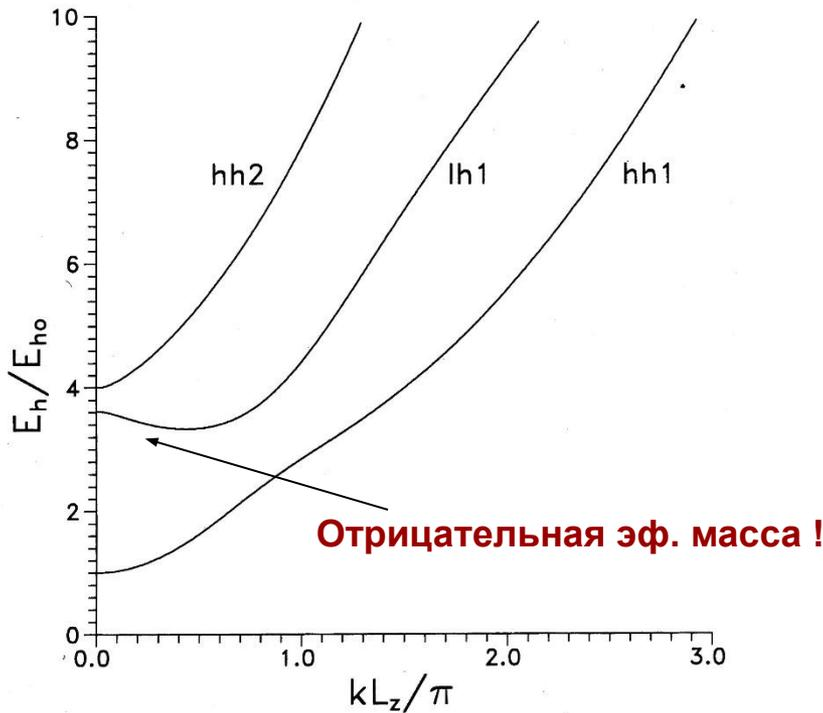
Расчет дисперсии дырок в валентной зоне с учетом смешивания зон и конечной глубины ямы в GaAs
