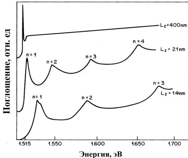
Образец многослойной гетероструктуры AlGaAs/GaAs, выращенной методом МПЭ для экспериментов по поглощению (Dingle и др).
