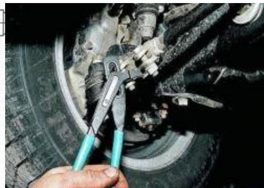
Проверка и регулировка схождения и развала колес
