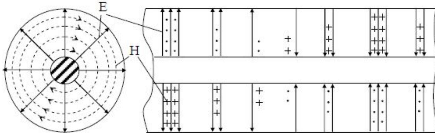
электрическая составляющая ЭМП имеет только радиальную, а магнитная – только азимутальную компоненты в цилиндрической системе координат  $r, \varphi, z$ :
