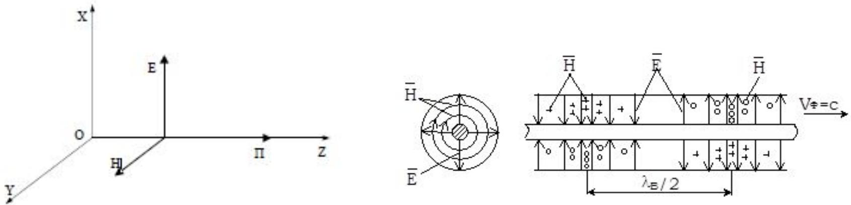
1. При  $E_z=0$  и  $H_z=0$  направляемую волну называют поперечной электромагнитной волной или Т-волной (Т – первая буква латинского слова transverses – поперечный). В поперечной электромагнитной волне векторы напряжённости электрического и магнитных полей лежат в плоскости, перпендикулярной направлению распространения. В диэлектрическом волноводе поперечная электромагнитная волна распространяться не может.
