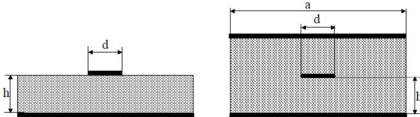
В несимметричной полосковой ЛП имеются два проводника, один из которых представляет собой металлическую полоску (полосок) постоянных размеров, другой – широкую металлическую пластину (подложку).
