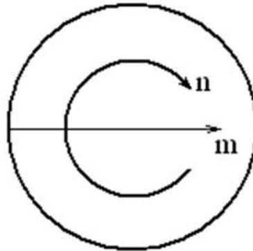
В теории применяется дополнительная классификация волн для конкретных линий передачи. Эта классификация учитывает изменения структуры поля в поперечных координатах. Она реализуется введением в обозначение типов волн (мод) индексов  $n$  и  $m$  ( $n, m = 0, 1, 2, \dots$ ).
