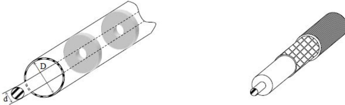
В коаксиальной ЛП могут существовать ЭМВ различных типов: Т, Е, Н и гибридные. Основной является Т-волна, остальные считают паразитными.
