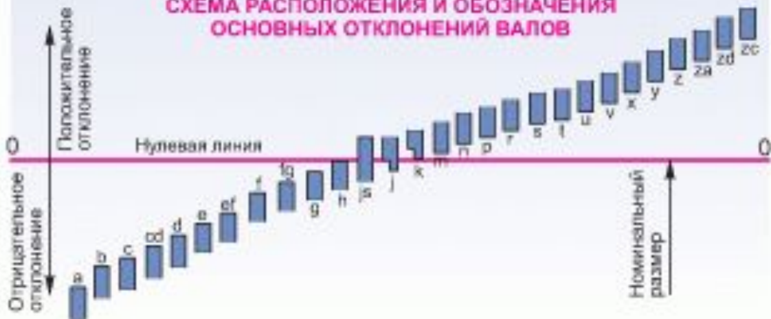
ПРИМЕРЫ ОБОЗНАЧЕНИЯ ПОЛЕЙ ДОПУСКОВ ВАЛОВ И ОТВЕРСТИЙ
