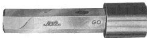
Рис. 3.12. Проходной калибр-пробка (P-IP)
