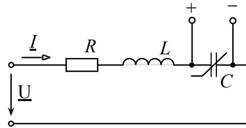
**Вариакапы.** Это одна из разновидностей полупроводникового диода, к которому подводится обратное напряжение, изменяющее ёмкость диода. Благодаря малым размерам, высокой добротности, стабильности и значительному изменению ёмкости, вариакапы широко применяются в РЭА для настройки контуров и фильтров.
