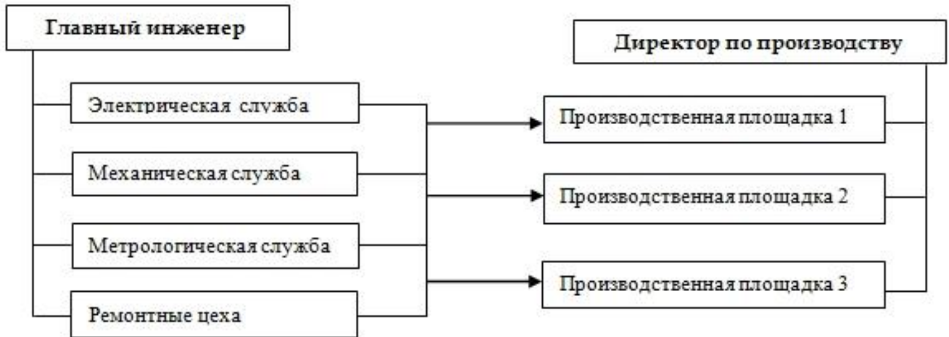
Рисунок 1 - Типовая централизованная организационная структура ремонтных служб предприятия
