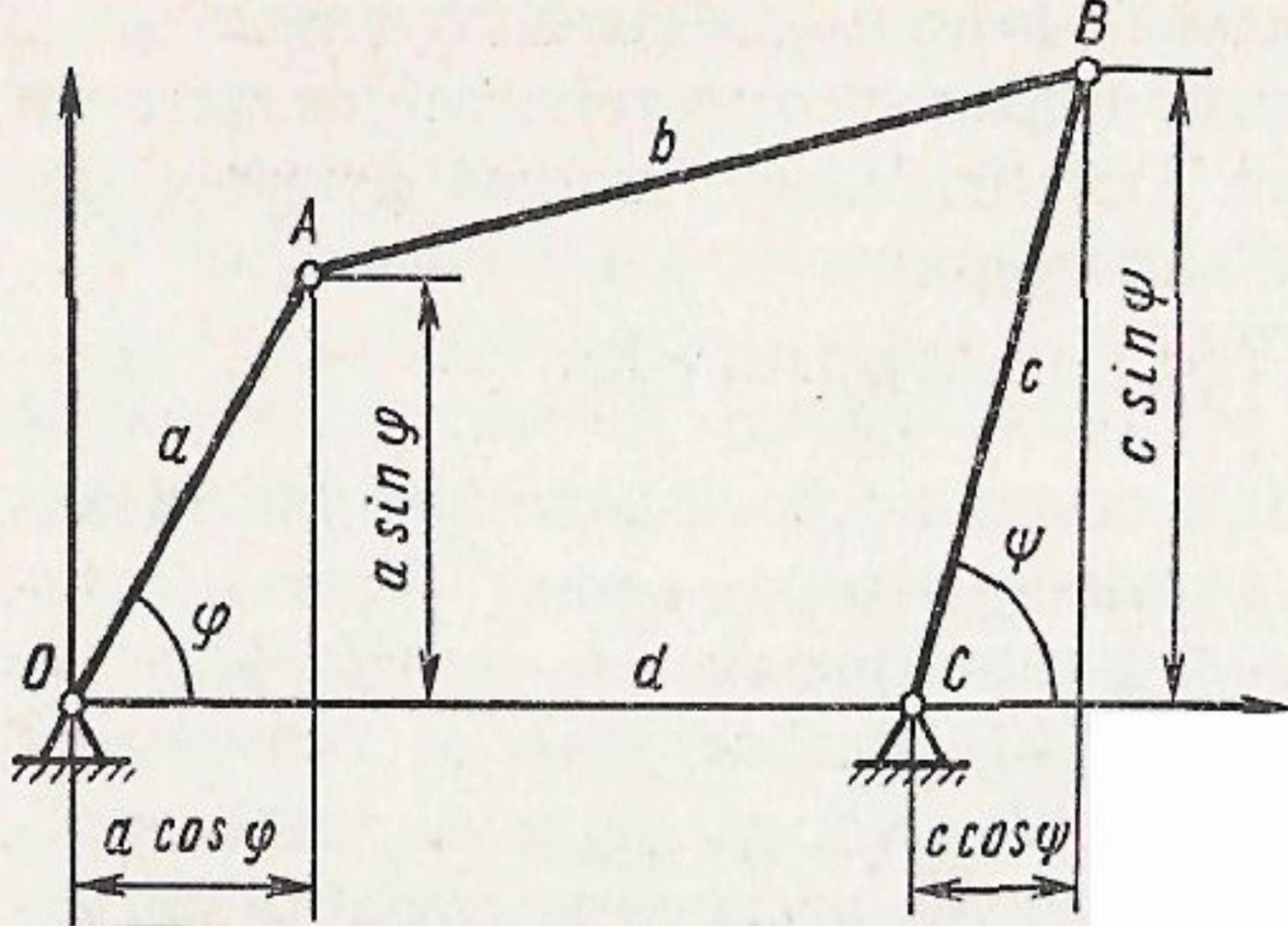
Схема плоского четырехшарнирника
