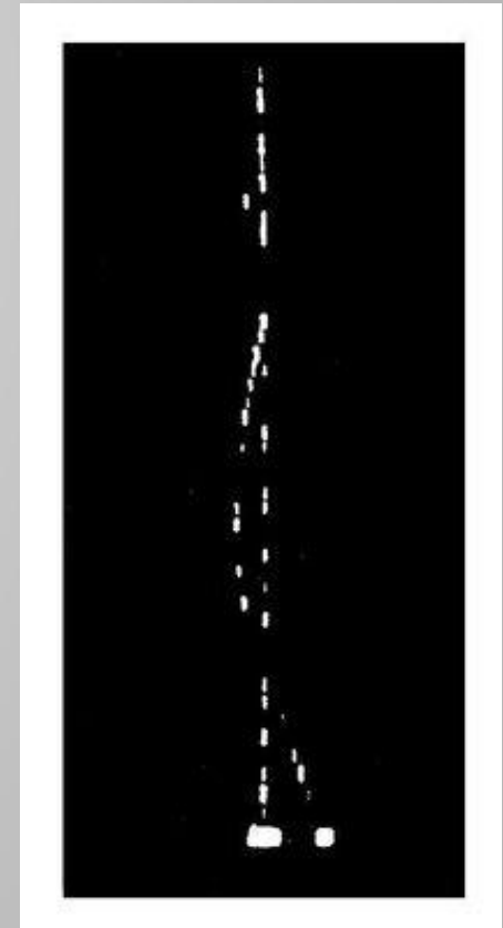
Трек частицы в узкоззорной искровой камере
