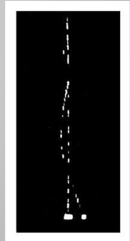
Трек частицы в узкоззорной искровой камере
