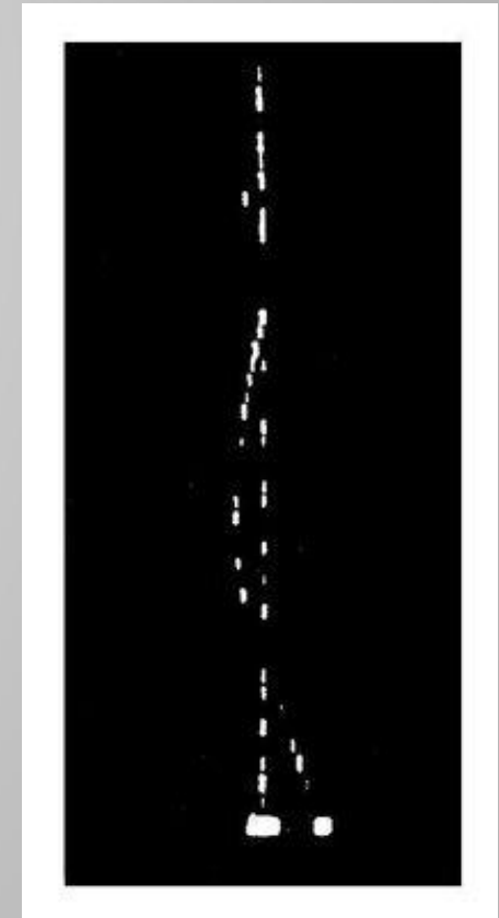
Трек частицы в узкозазорной искровой камере
