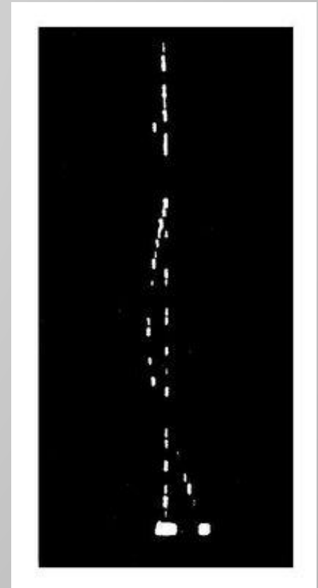
Трек частицы в узкоззорной искровой камере
