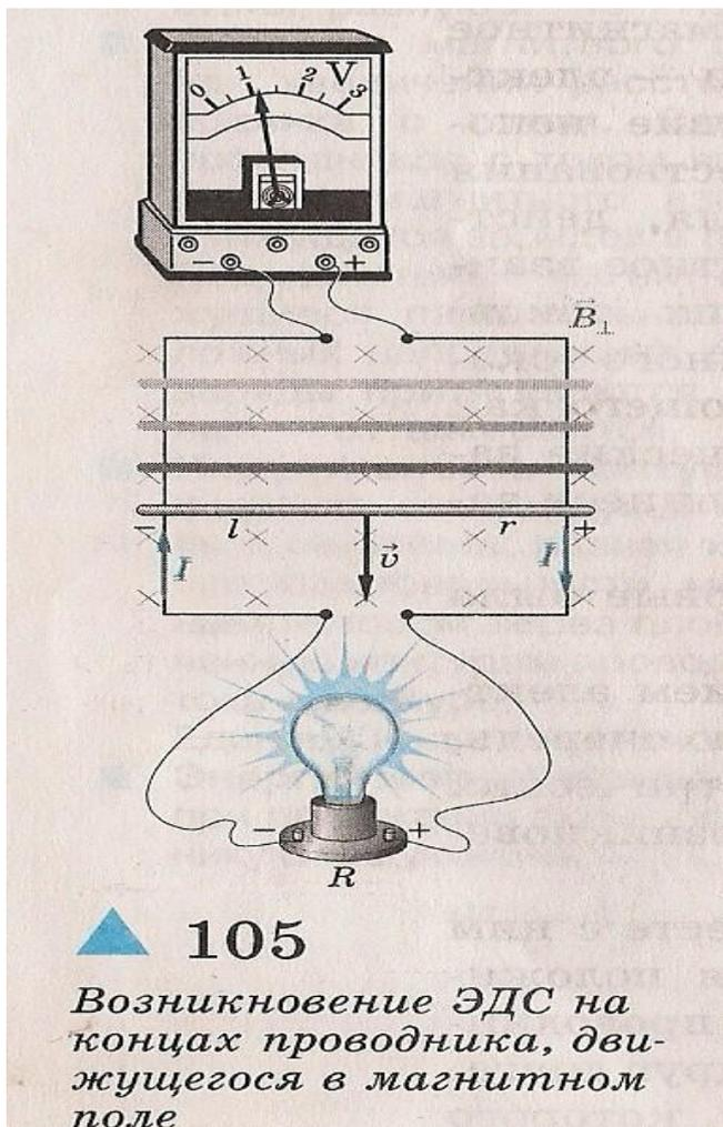
ЭДС индукции. На концах проводника, движущегося в магнитном поле, возникает разность потенциалов, или ЭДС индукции:
