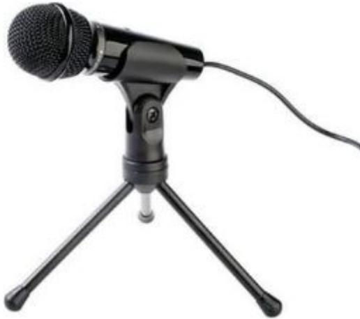
Электродинамический микрофон состоит из: постоянного магнита, в промежутке между полюсами магнита находится катушка, каркас которой соединен с мембраной.
