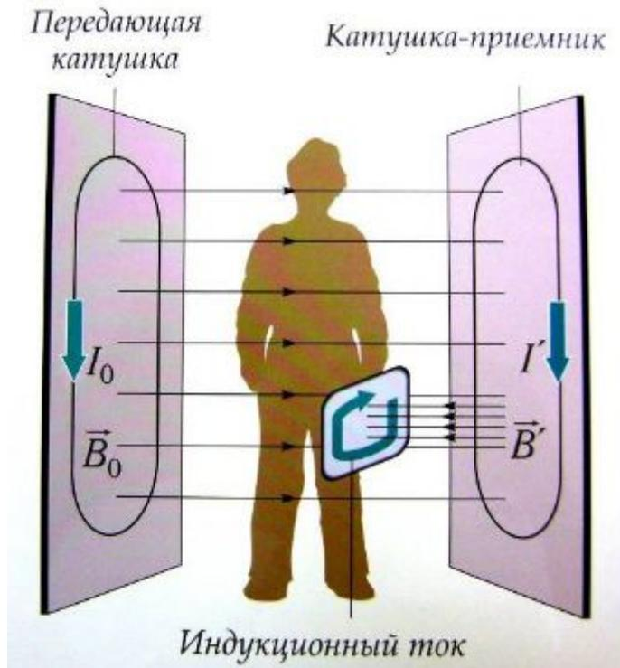
Для обнаружения металлических предметов применяются специальные детекторы. Например, в аэропортах детектор металла фиксирует поля индукционных токов в металлических предметах
