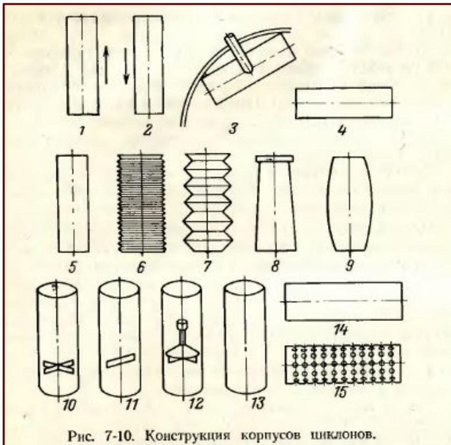
Рис. 7-10. Конструкция корпусов циклонов.
