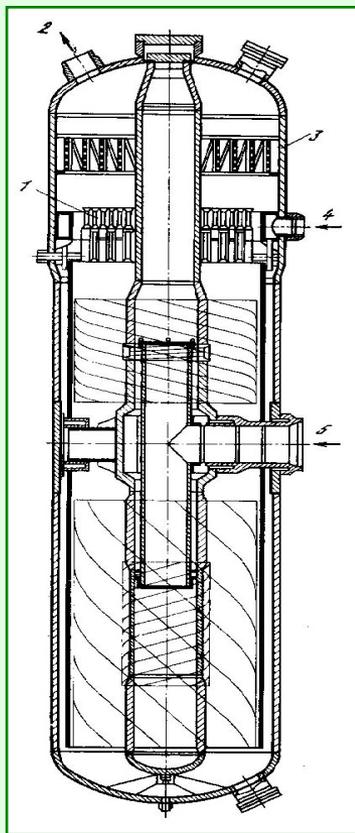
**ПГ со змеевиковыми трубками**
