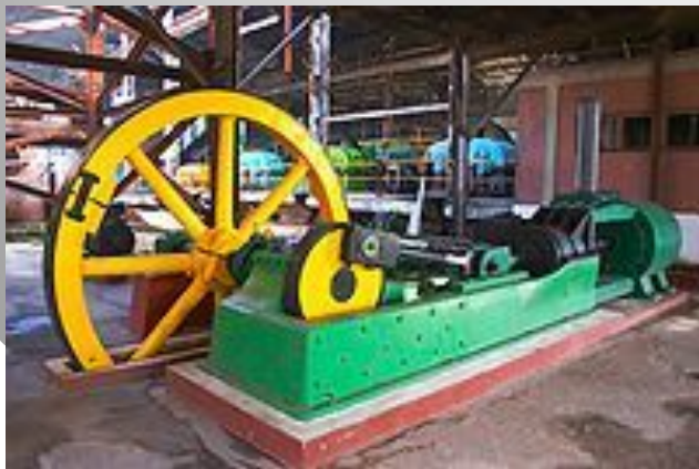
Паровая машина на старой сахарной фабрике, Куба
