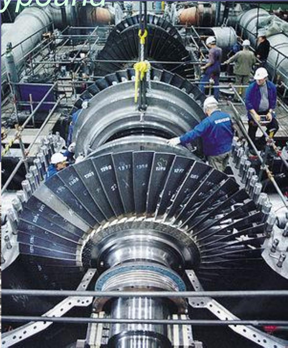
*Паровáя турбíна (фр. *turbine* от лат. *turbo* вихрь, вращение) — это тепловой двигатель непрерывного действия, в лопаточном аппарате которого потенциальная энергия сжатого и нагретого водяного пара преобразуется в кинетическую, которая в свою очередь совершает механическую работу на валу.*
