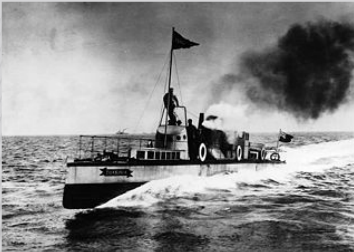
«TURBINIA» — опытное судно Чарлза Парсонса
