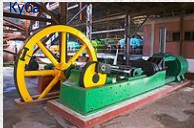
Паровая машина на старой сахарной фабрике, Куба
