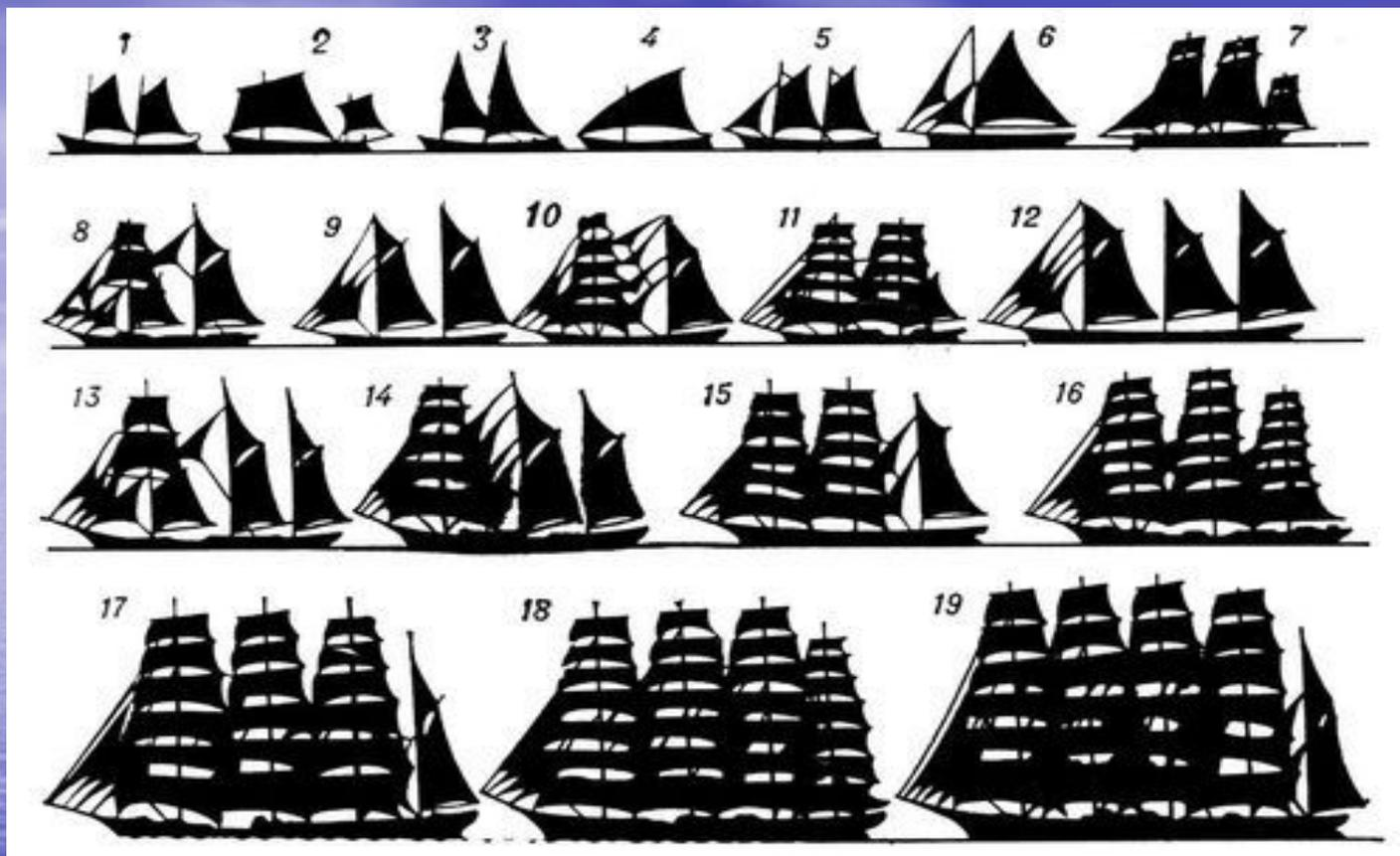
Силуэты парусных судов: 1 — со шпринтовым парусным вооружением; 2 — с рейковым парусным вооружением; 3 — с бермудским парусным вооружением; 4 — с латинским парусным вооружением; 5 — с гафельным парусным вооружением; 6 — куттер; 7 — люгер; 8 — шхуна-бриг; 9 — двухмачтовая шхуна; 10 — бригантина; 11 — бриг; 12 — трёхмачтовая шхуна; 13 — шхуна-барк; 14 — баркентина; 15 — трёхмачтовый барк; 16 — фрегат; 17 — четырёхмачтовый барк; 18 — четырёхмачтовый корабль; 19 — пятимачтовый барк.
