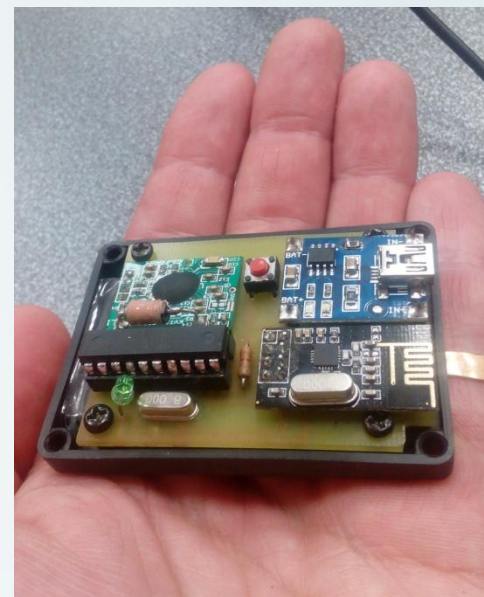
Приемник, подключаемый к ПК (без верхней крышки корпуса)
