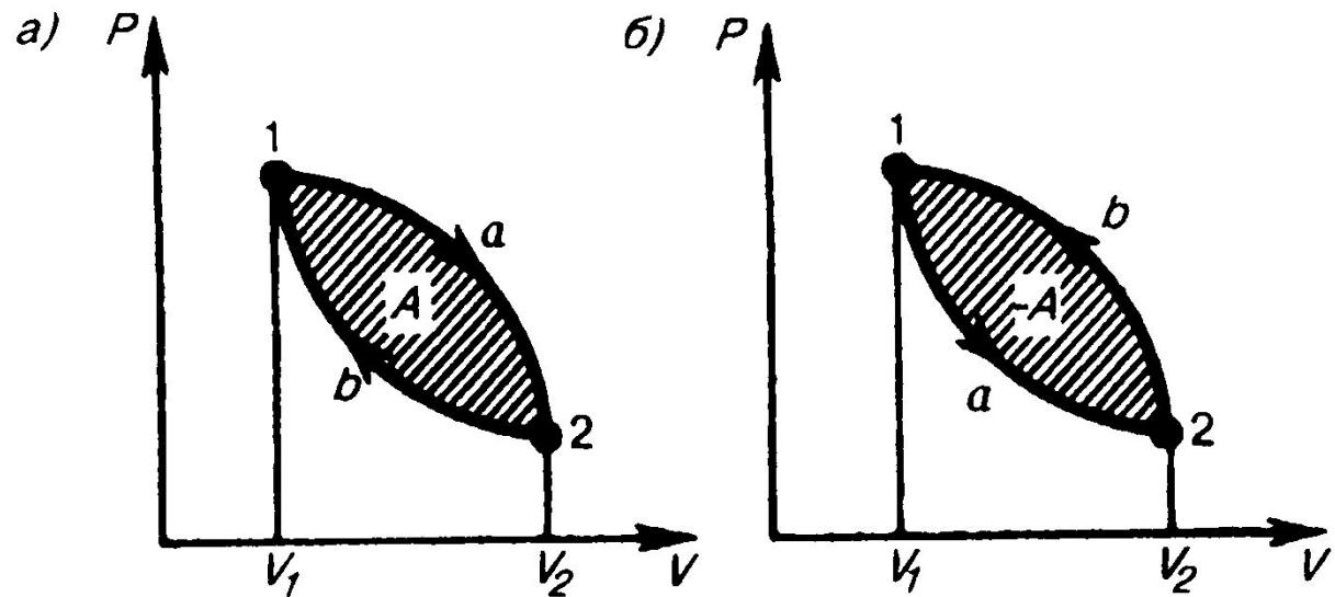
Работа расширения (определяется площадью фигуры  $1a2V_2V_1$  ) положительна ( $dV > 0$  ), работа сжатия (определяется площадью фигуры  $2b1V_1V_2$  ) отрицательна ( $dV < 0$ ).
