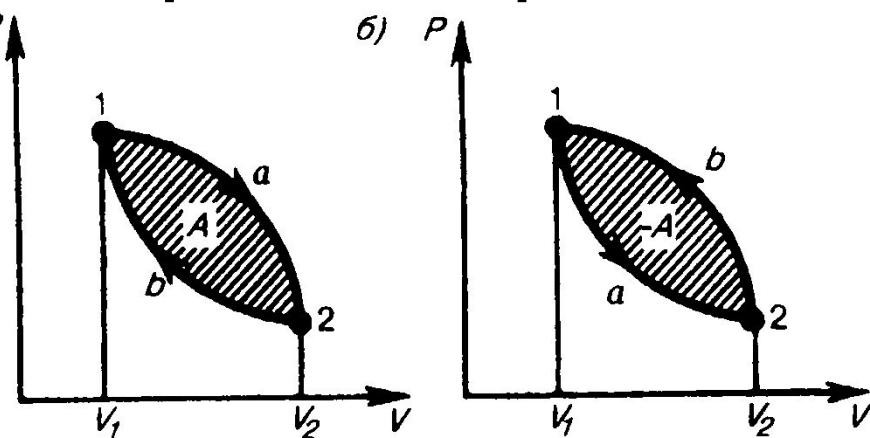
Прямой цикл используется в тепловых двигателях – периодически действующих установках, совершающих работу за счет получения извне теплоты. Обратный цикл используется в холодильных машинах периодически действующих установках, в которых за счет работы внешних сил теплота переносится к телу с более высокой температурой.
