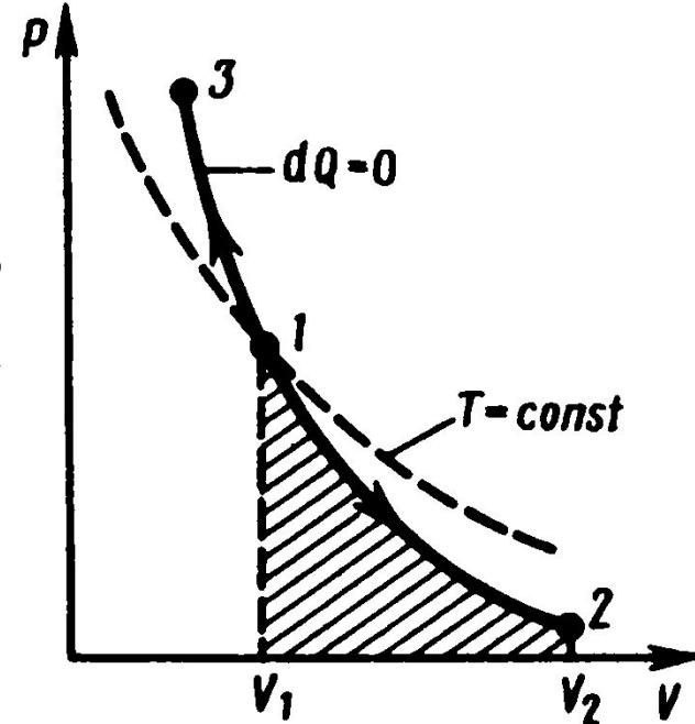
Вычислим работу, совершающую газом в адиабатическом процессе. Запишем уравнение (55.1) в виде
