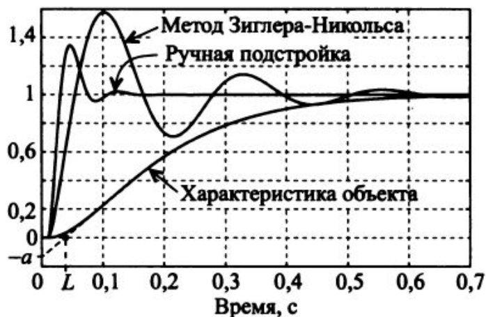
Рис. 5.84. Результат настройки ПИД-регулятора по методу Зиглера-Никольса для объекта второго порядка с задержкой: T_1 = T_2 = 0,1 с, L = 0,01 с
