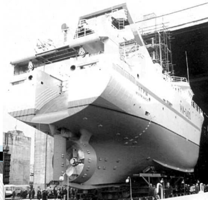
Неподвижная направляющая насадка траулера типа «Ягры»
