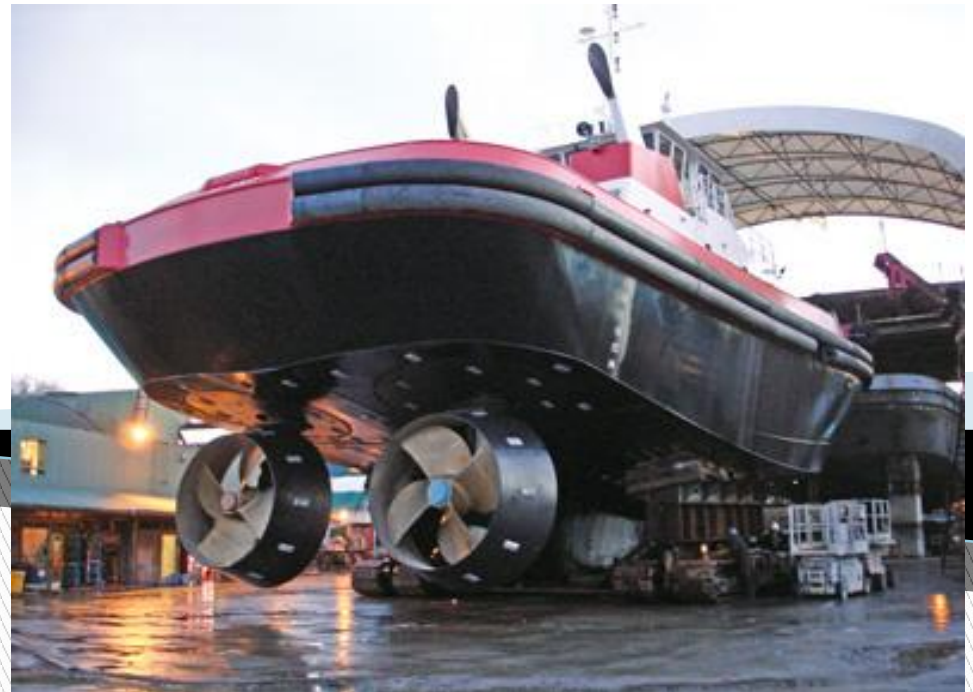
Схема размещения винто-рулевых колонок на буксире
