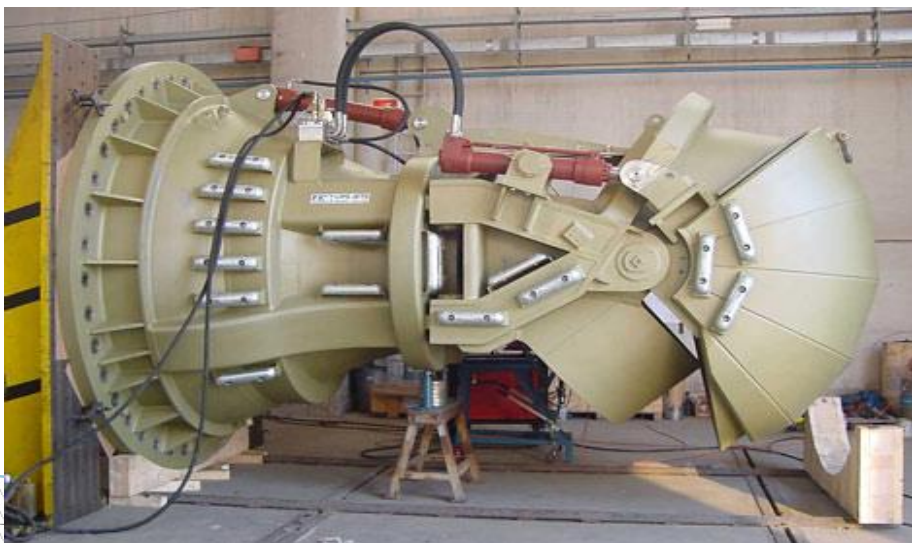
Рис.а Водомет с осевым насосом фирмы HYFLO
