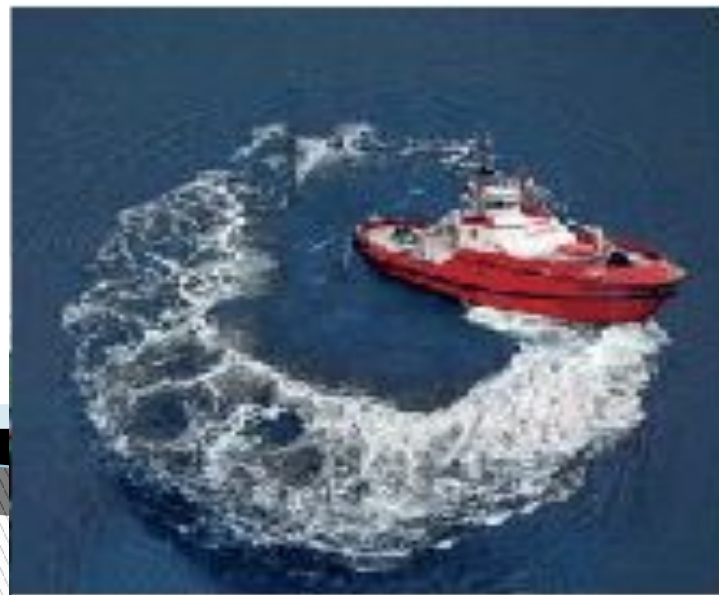
Циркуляция судна с крыльчатым двигателем
