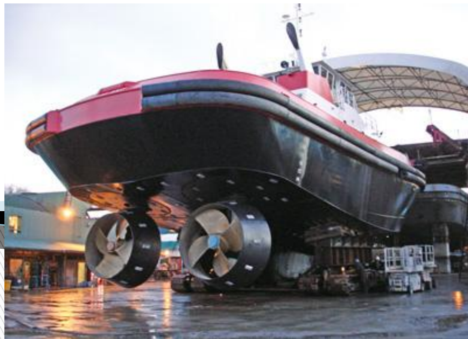
Схема размещения винто-рулевых колонок на буксире
