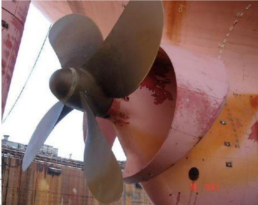
Рис. а. Гребной винт фиксированного шага (ВФШ)
