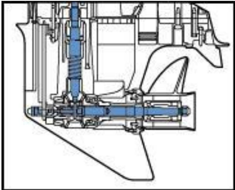
Смазка данных узлов предполагает собой использование в условиях экстремального давления. Рекомендуемая вязкость EP SAE 90.
