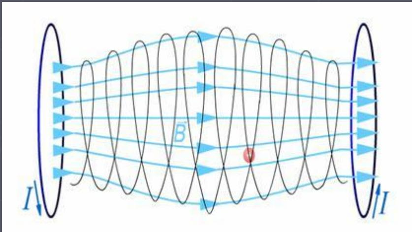
► В неоднородном магнитном поле, созданном, например, 2-мя кольцами с электрическим током, движение частицы, влетающей под углом к вектору  $\vec{B}$ , движение частицы будет более сложным, частица ведёт себя, как попавшая в магнитную ловушку.
