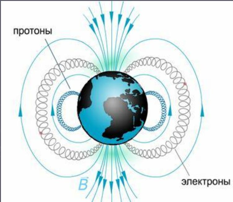
Магнитное поле защищает поверхность Земли от по-Падания огромного коли-чества заряженных частиц, в основном со стороны Солнца. Они отклоняются от Земли, Либо захватываются магнитным полем Земли и сосредотачиваются в определённых радиационных поясах, в которых движется по сложным траекториям, колеблясь между северным и южным магнитными полюсами Земли, вызывая у полюсов свечение атмосферы.
