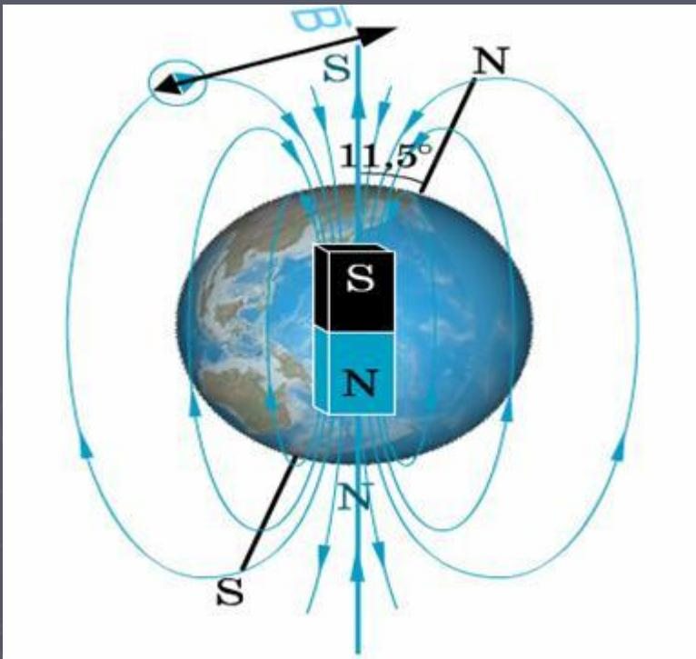
▶ Исследуя магнитное поле Земли с помощью компаса можно установить, что расположение линий магнитной индукции Земли напоминает картину линий магнитного поля полосового магнита, ось которого повернута относительно оси вращения Земли на 11 градусов, т.о. южный магнитный полюс Земли располагается не на её вершине, а в 1200 км от него.
