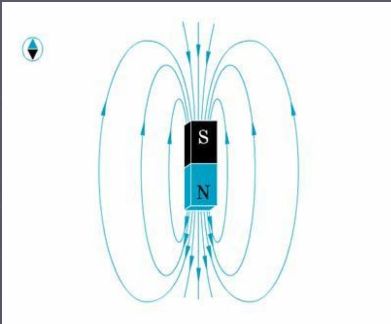
Линии индукции магнитного поля показывают, как направлен вектор индукции магнитного поля в каждой точке пространства вокруг источника магнитного поля. Густота линий показывает, где индукция магнитного поля больше по модулю.
