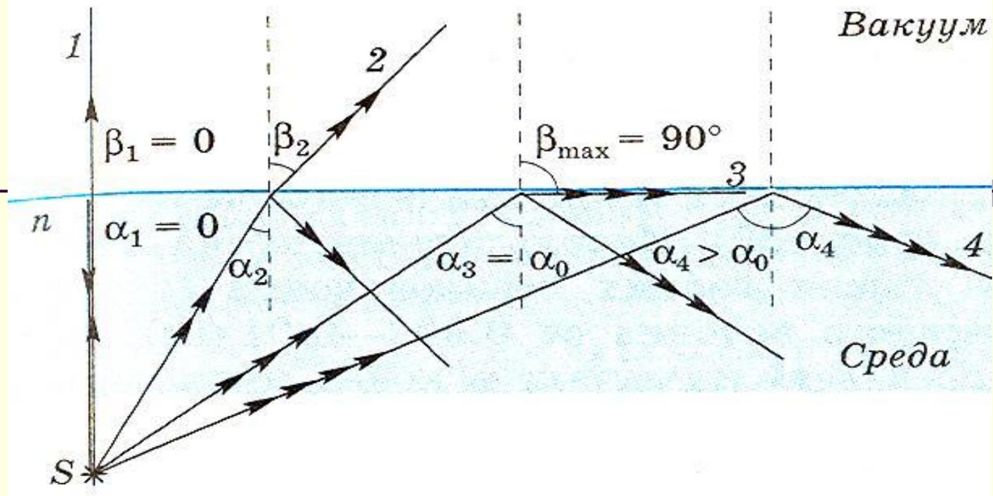
При переходе света из оптически более плотной среды в менее плотную свет как преломляется, так и отражается. С ростом угла падения  $\alpha$  возрастает и угол преломления  $\beta$  ( $\beta > \alpha$ ).
