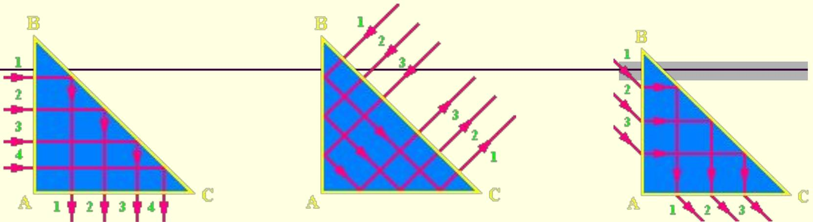
В первом случае призма позволяет поворачивать световой пучок на  $90^\circ$ , поэтому ее называют *поворотной*. Внутри призмы наблюдается однократное внутреннее отражение от грани **BC**.
