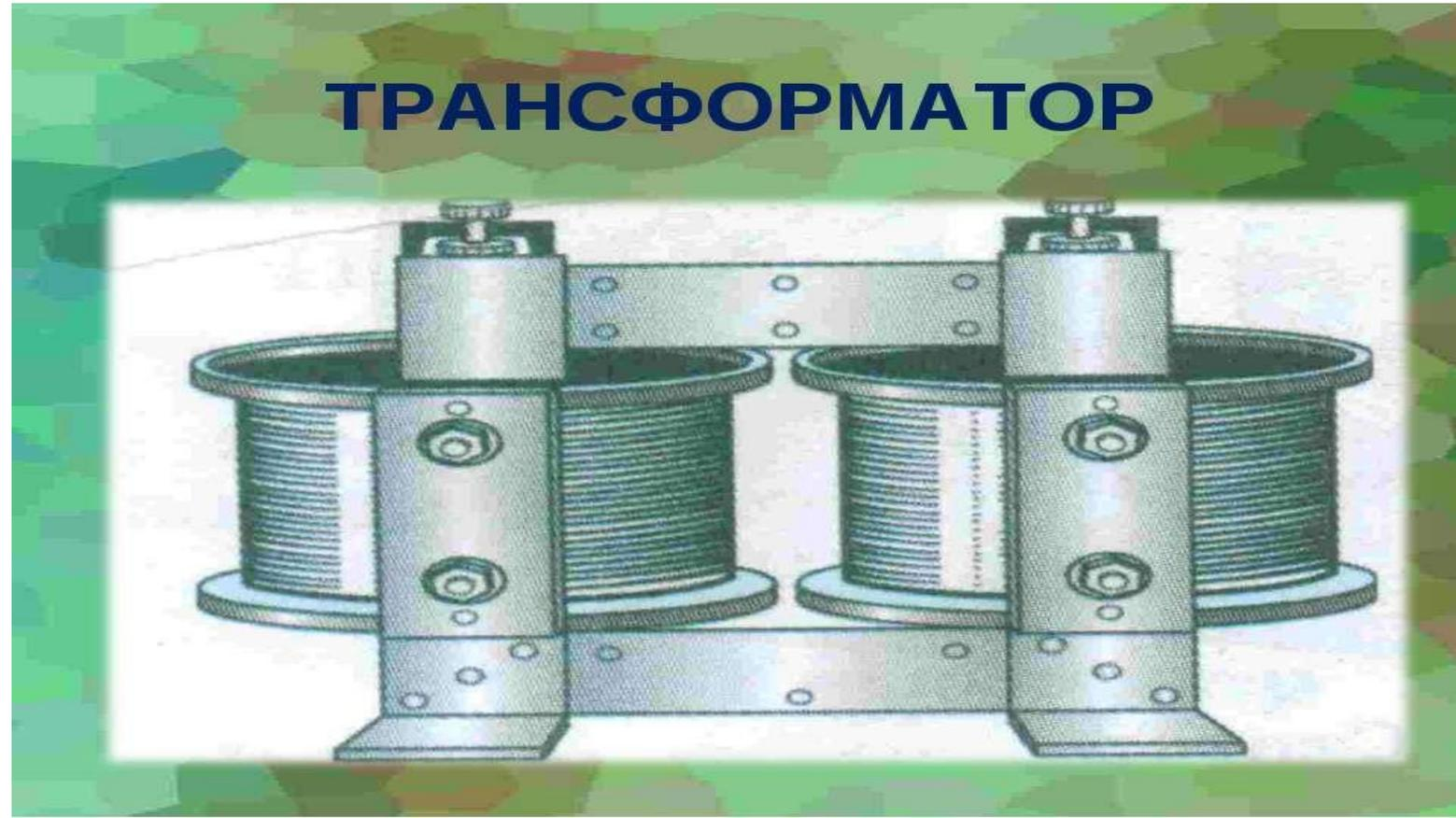
Вернемся к вопросу о передачи электроэнергии . Напряжение, вырабатываемое генератором, обычно не превышает 25кВ. Поэтому ток с электростанции сначала подается на расположенную неподалеку, повышающую трансформаторную подстанцию, где напряжение повышается до нескольких сотен киловольт (обычно это 750 кВ), и под таким напряжением подается в ЛЭП. И в конце линии поочередно на несколько трансформаторных подстанций, понижающих напряжение до 380 или 220 В, а затем – на предприятия или в жилые дома.
