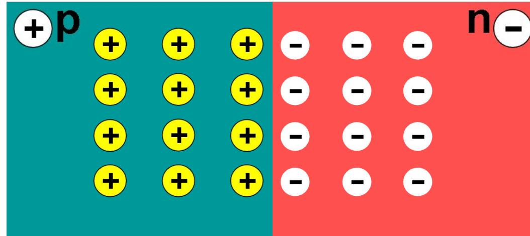
Электрическая проводимость р-типа определяется дырками, поэтому их называют здесь основными носителями заряда, а электроны проводимости - не основными. В полупроводнике н-типа - наоборот.
