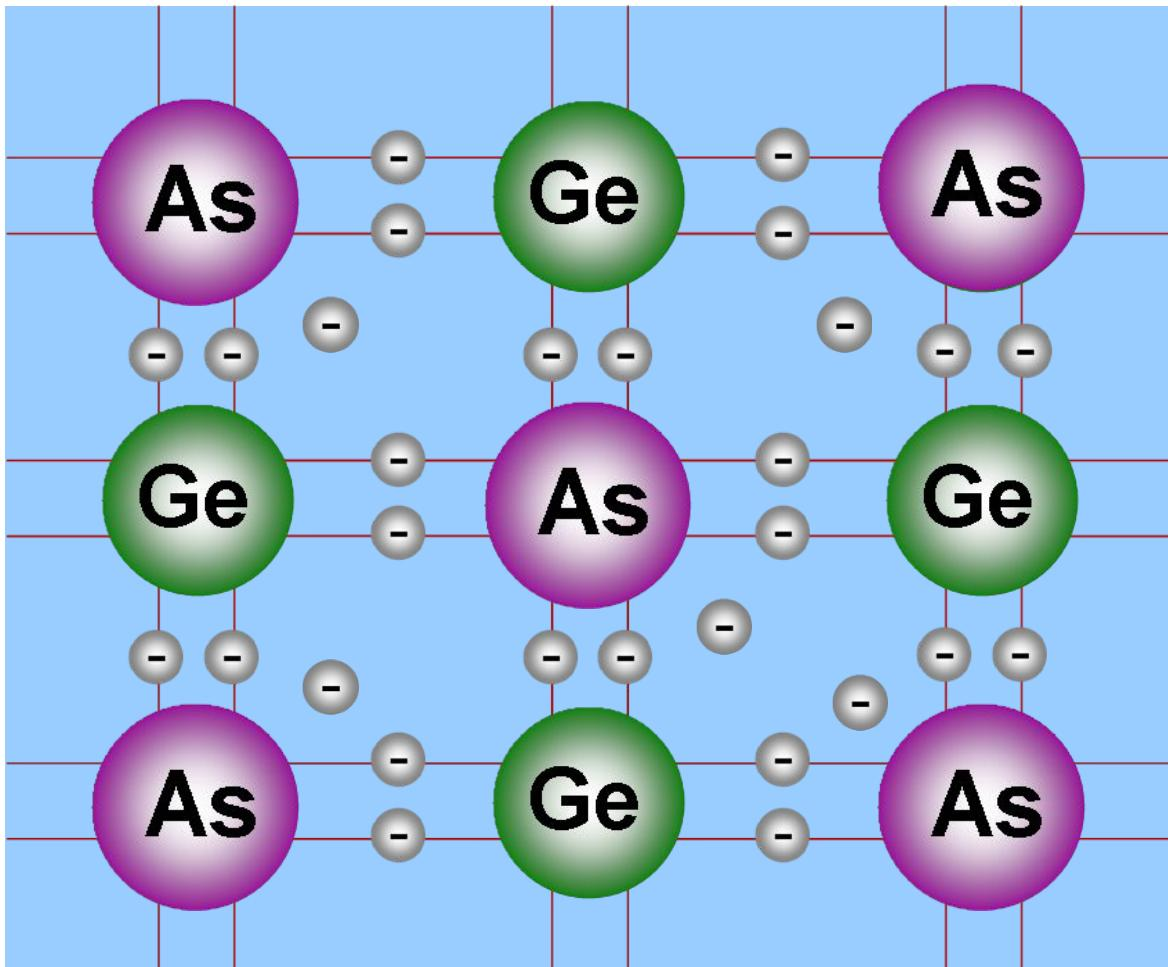
Электронная проводимость возникает, когда в кристалл германия с четырехвалентными атомами введены пятивалентные атомы (например, атомы мышьяка, As).
