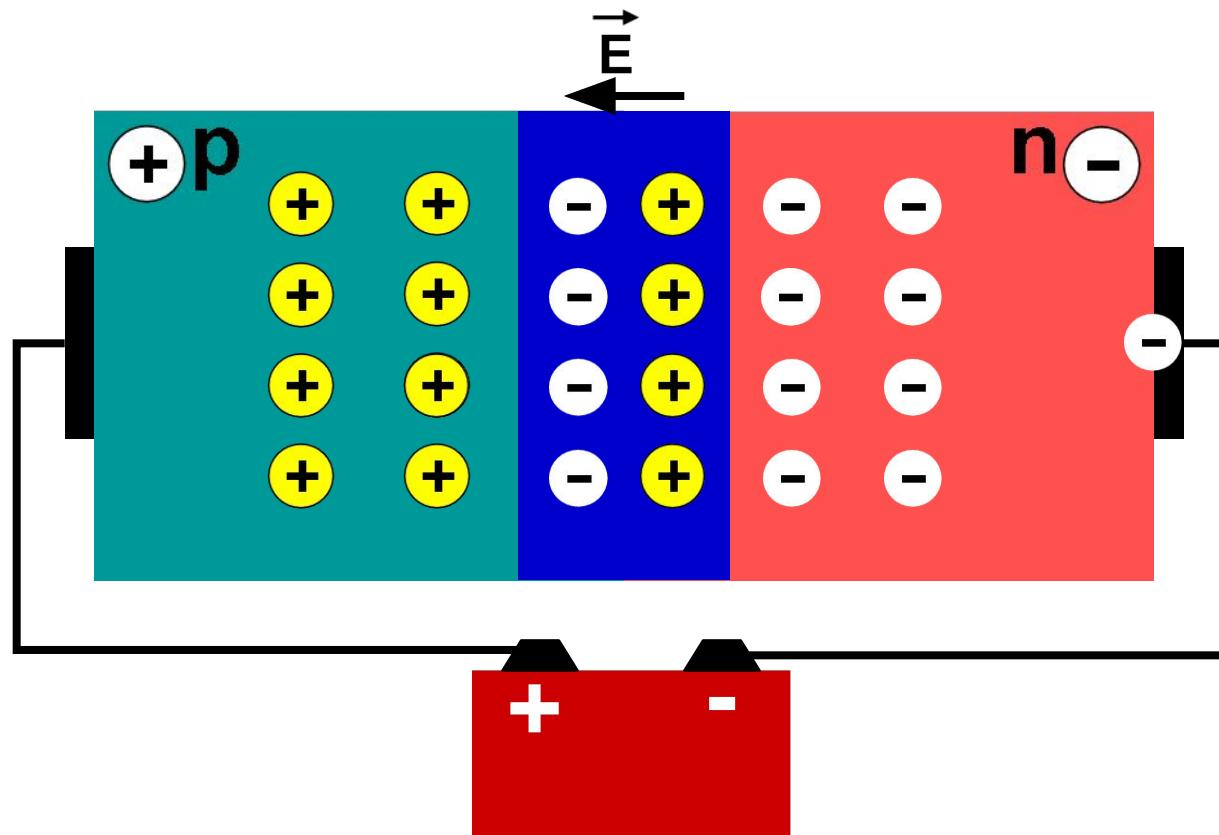
Способность p–p-перехода пропускать ток практически только в одном направлении используется в приборах, которые называются полупроводниковыми диодами.
